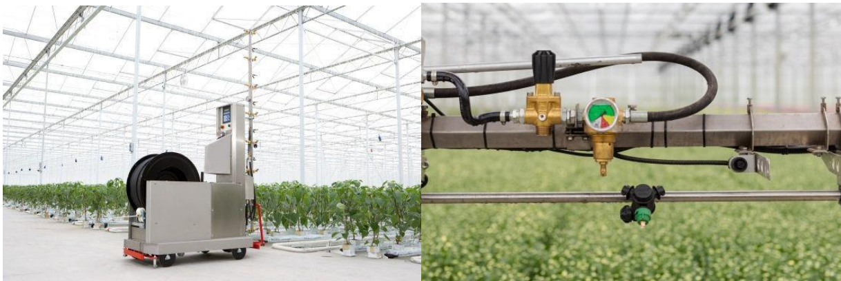
Robot de stropit autopropulsat în sere și rampă de stropit pentru aplicarea pesticidelor în volum foarte mic (ULV)
