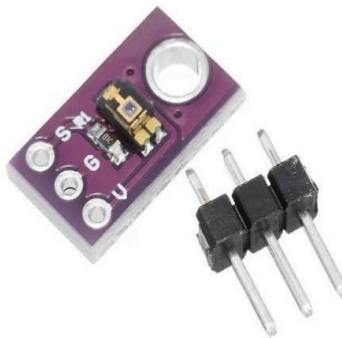
SEQ ábra 1* ARABIC 4. ábra Analóg fényerősség mérő szenzor
