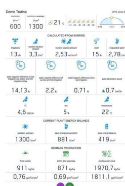
A Gremon Systems, Trutina növényházvezérlő szoftverének grafikus felhasználói felülete és a növények mérésére szolgáló szenzorok
