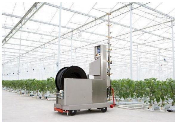
Önjáró, üvegházi permetezőrobot és ultra alacsony mennyiségű növényvédő szer kijuttatására alkalmas szórókeret
