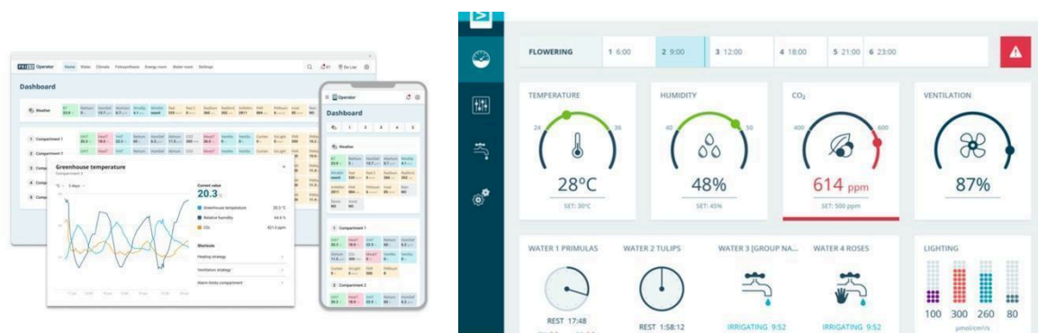
Interfețe grafice operaționale ale sistemul de control Priva Operator
