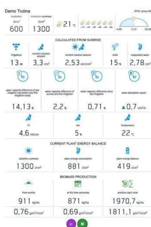
Графички кориснички интерфејс софтвера за контролу стакленика Gremon Systems Trutina и сензори за мерење биљака
