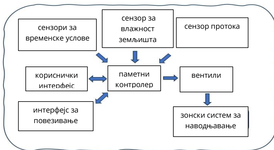
Интелигентна структура система за наводњавање
